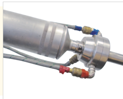
Medienkopf der Messsonde mit Kamerabehälter und Anschlüssen für die Kühlmittel
