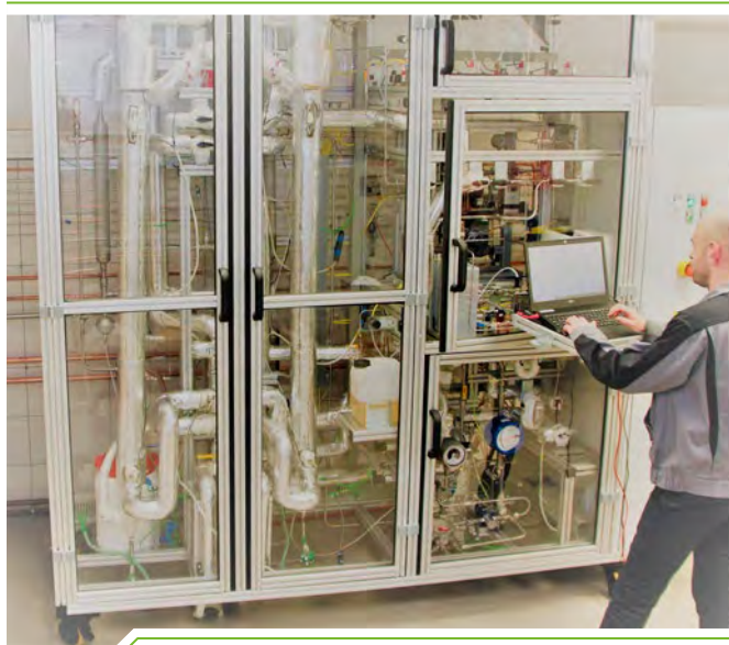
Halbtechnische Demonstrationsanlage zur Synthese von Methanol / DME
