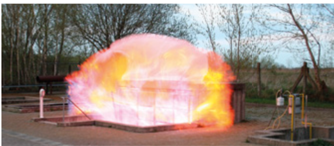
Gasexplosion im geschlossenem Kellerraum
